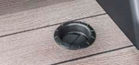
1 Presa d'aria calda aggiuntiva
