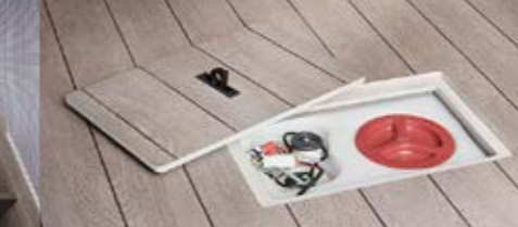
5 Apertura per pulizia serbatoio dell'acqua chiara
